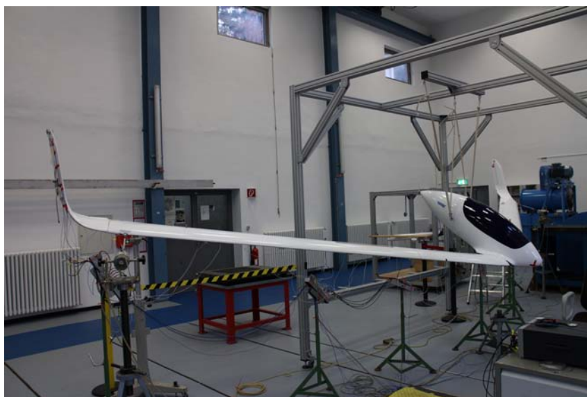
Das AK-X 1:2 Modell auf dem Prüfstand beim DLR. Foto: Akaflieg Karlsruhe.
